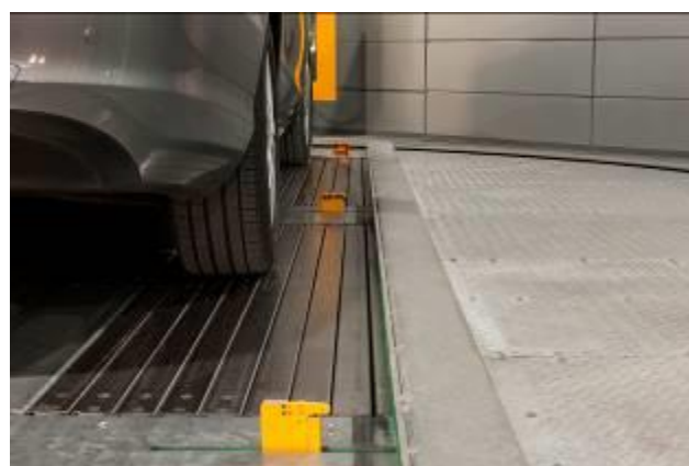
In den Übergabebereichen befinden sich seitliche Sensoren. Foto: Edgardo Contreras, Luis Sánchez Núñez de Cáceres
